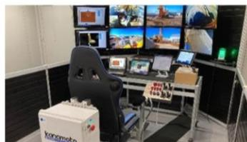
建設機械遠隔操作システム
